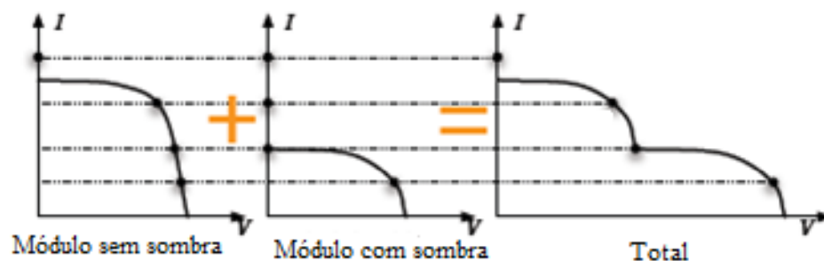
Fig. 6 – Efeito do sombreamento nos sistemas fotovoltaicos.
