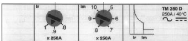
Figura 4: Painel de regulação do relé electrónico TM250D. (Fonte Schneider Electric)
