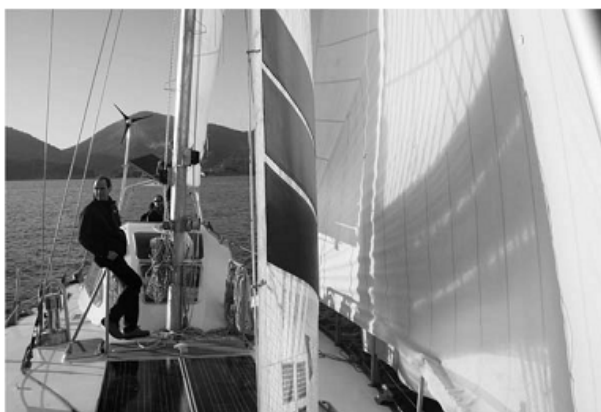
Figura 3 - Integração de painéis de TFPC (orgânico) num barco à vela em Itália [5]
