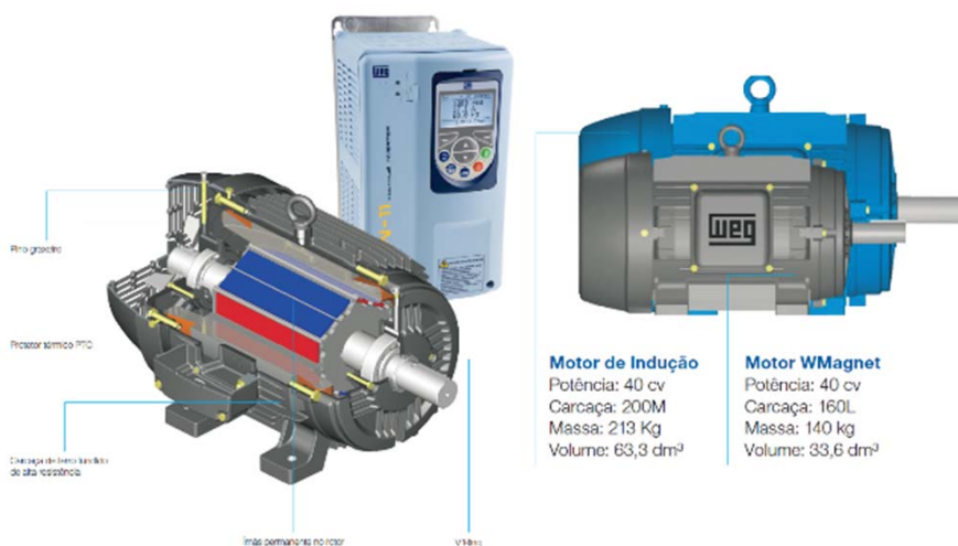
Figura 2. Motor de ímãs internos de terras-raras e carcaça reduzida.
