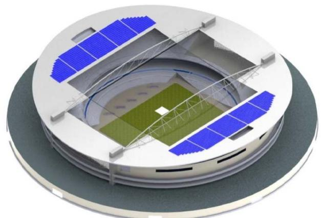
Figura 10. Implementação em 3D da central fotovoltaica na cobertura do Estádio do Dragão [5].
