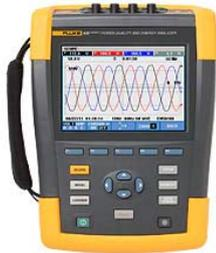
Figura 7. Analisador de energia [2]
