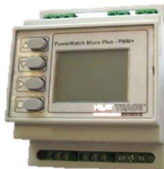
**Figura 6. Controlador de temperatura**
