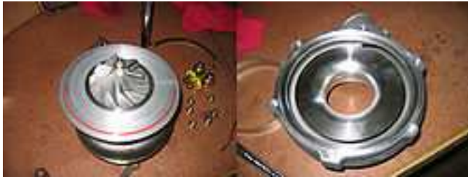
Figura 9 - Lado do rotor impelidor, compressor, com a tampa removida [6]
