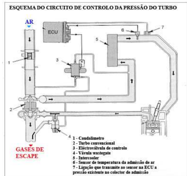
Figura 15 - Esquema do circuito de controlo da pressão de um turbo convencional [5]
