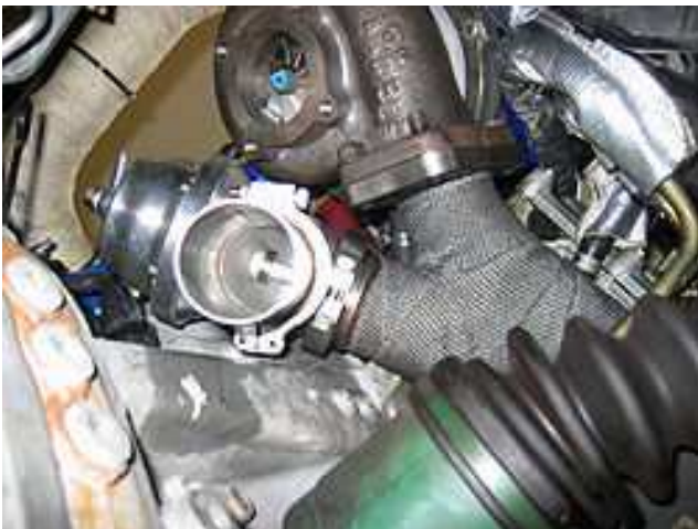
Figura 11 - Uma válvula de descarga ( wastegate ) instalada ao lado do turbo. [6]
