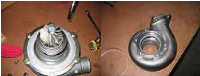
Figura 10 - Lado da turbina, com a tampa removida. [6]
