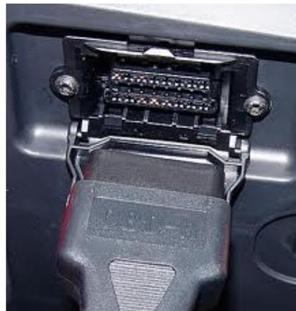
**Figura 5 – Ligação OBD2 onde existe uma ligação do protocolo CANBus**
