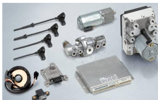
Figura 11- Componentes do sistema ESP [8]
