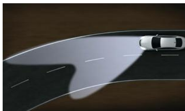
Figura 19 – Sistema de iluminação adaptativa [13]
