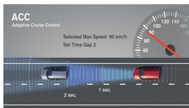
Figura 15 – Funcionamento do sistema ACC [12]
