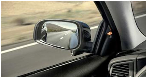
Fig. 13. Fotografia do sistema BLIS em funcionamento, detectando um veículo no ângulo morto de visão do condutor
