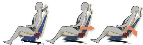
Fig. 23. Exemplo do funcionamento do WHIPS
