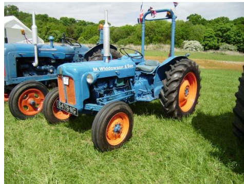
Fig. 20. Exemplo da utilização do ROPS (visível pela barra de segurança) num tractor agrícola da marca FORD.
