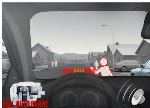
Fig. 17. Exemplo da situação em que um peão é detectado na frente do carro a uma distância não considerada segura, caso em que os travões são accionados prontamente
