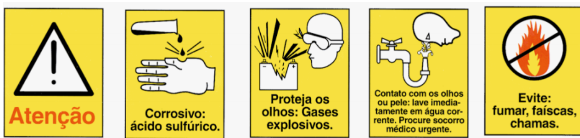
Figura 84 Simbologia própria utilizada internacionalmente para identificar as regras de segurança aplicáveis na manutenção de baterias de automóveis ([12])
