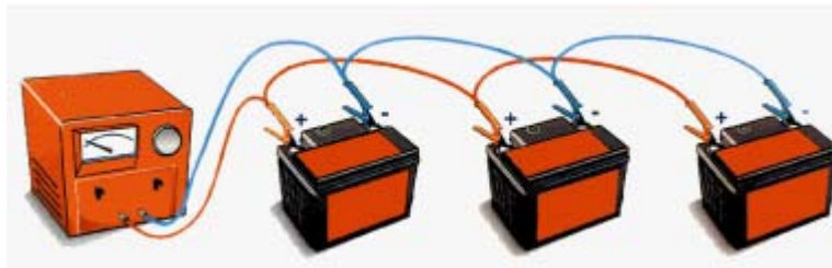
Figura 86 Operação de carga de mais do que uma bateria em paralelo([10])
