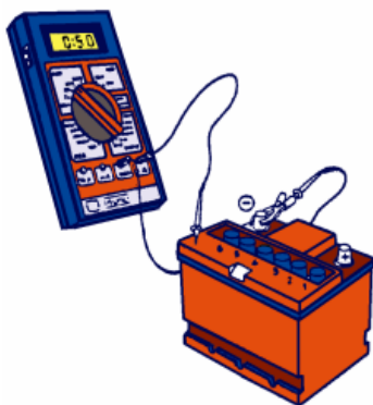
Figura 88 Verificação da existência de fuga de corrente de uma bateria ([10])
