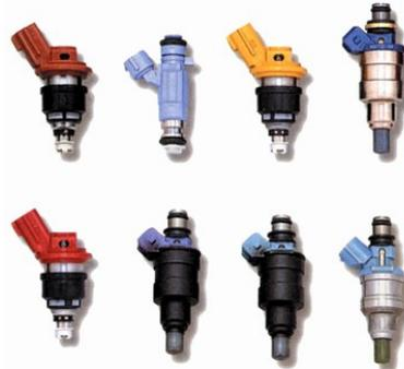
Figura 8 Tipos de injectores
