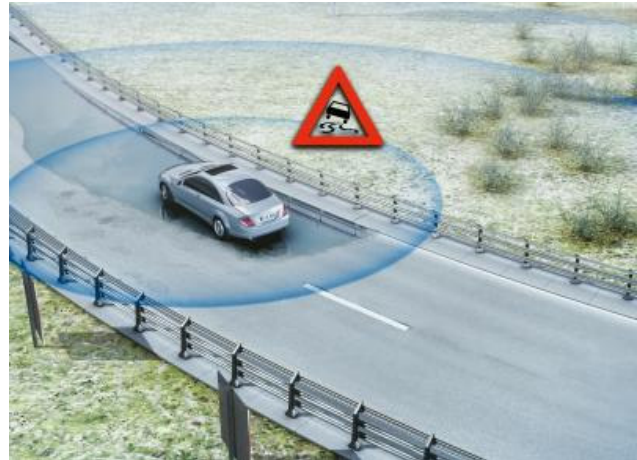
Fig. 10 – Veículo adquire estado da Estrada para informar outras viaturas
