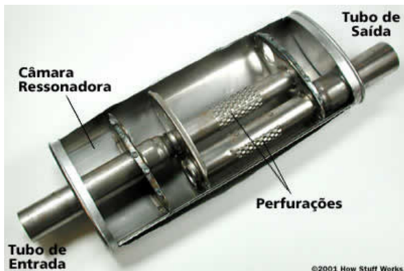
Figura 11 – Por dentro de um silenciador
