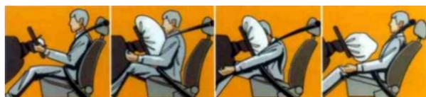
Ilustração 9 Simulação de um embate que provoca a activação do airbag
