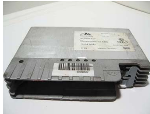
Figura 5: unidade de controlo electrónico (ECU).
