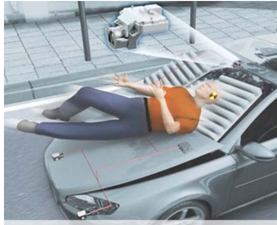
Figura 19: Sistema de protecção de peões.
