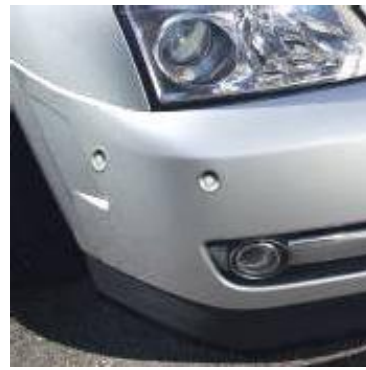
Figura 14: Sensores de ultra-sons instalados no pára-choques
