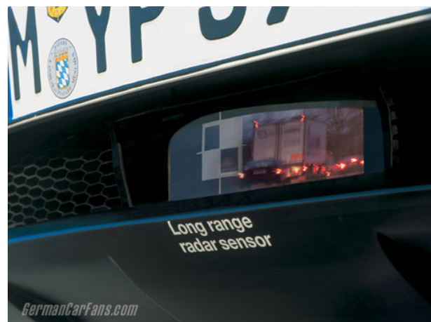
Figura 11: Sensor ACC instalado na parte dianteira do automóvel
