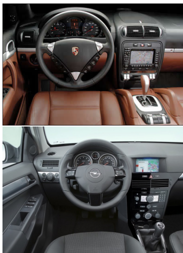
Figura 19: Monitores de GPS/Multimédia
