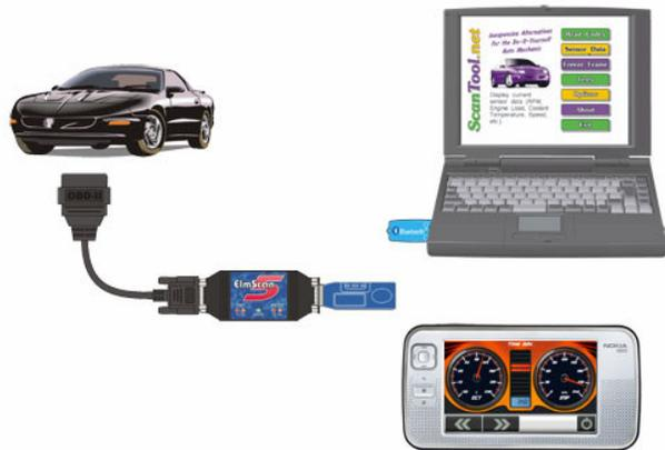
**Figura 11** – Diagrama de ligação *wireless* veículo / PC
