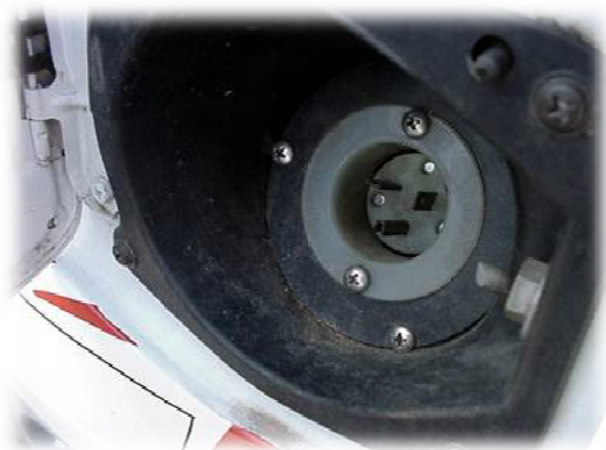
Figura 9 - tomada de 120/240V para recarregar as baterias
