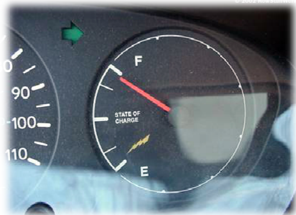
Figura 10 - Voltímetro no painel, indicando o nível de carga existente.
