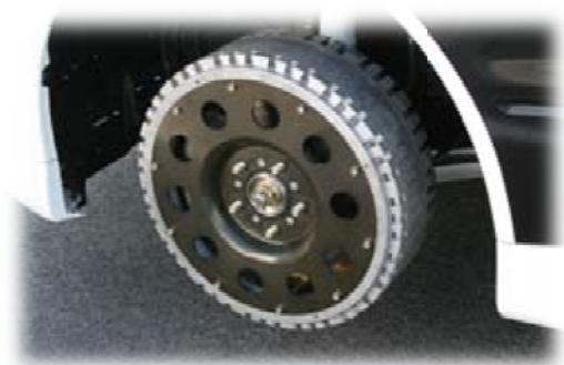
Figura 11 - Novo motor na roda com rotor exterior
