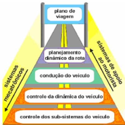
Figura 3: Estrutura dos diferentes níveis de controladores
