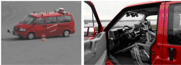
Figura 11: *Autonomes Fahren* (Volkswagen) – robô condutor
