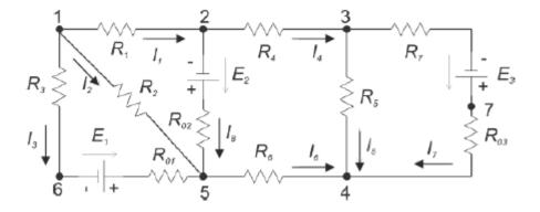
Calcule a corrente que percorre cada uma das resistências dos circuitos apresentados na figura seguinte.
