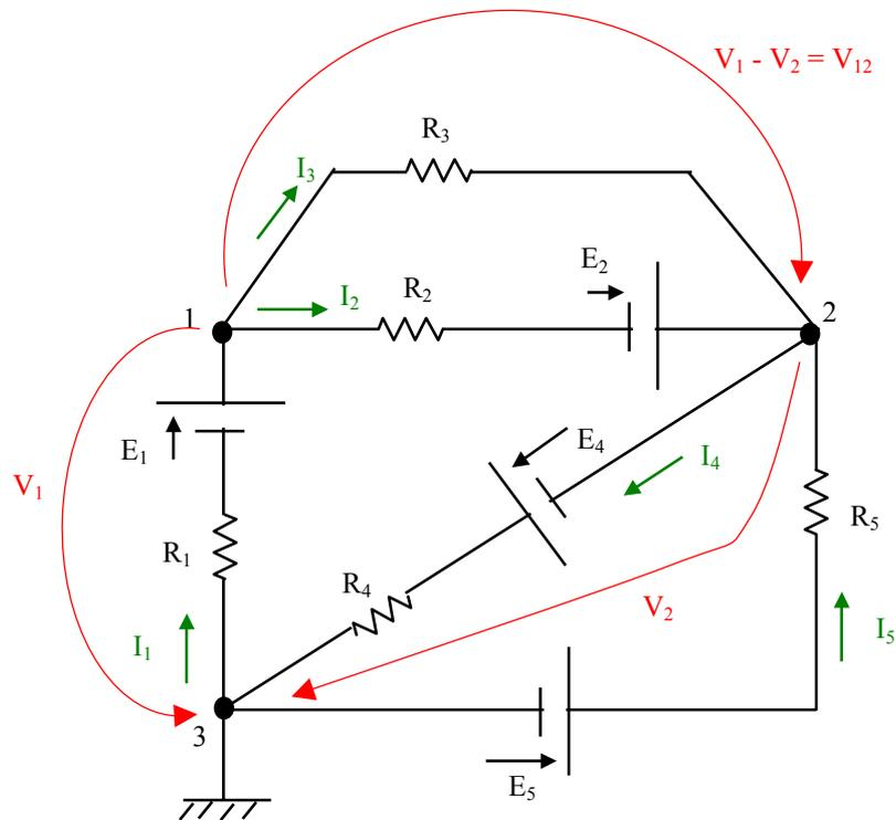
$$\text{equações de nós} \quad \left| \begin{array}{l} I_1 = I_2 + I_3 \quad (\text{nó 1}) \rightarrow I_1 - I_2 - I_3 = 0 \\ I_2 + I_3 - I_4 + I_5 = 0 \quad (\text{nó 2}) \end{array} \right.$$
