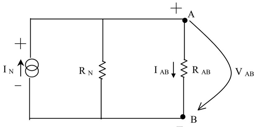
$R_N$  → Resistência equivalente do circuito entre os pontos A e B, quando se curto-circuitam todas as fontes de tensão (independentes) e se abrem todas as fontes de corrente (independentes) do circuito.
