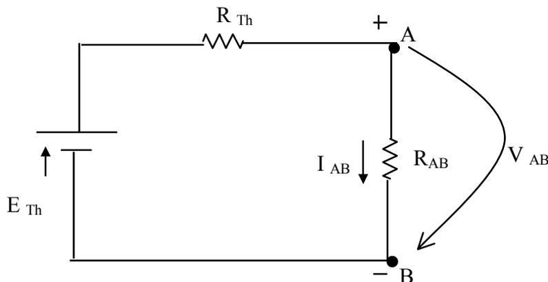
$R_{Th}$  → Resistência equivalente do circuito entre os pontos A e B, quando se curto-circuitam todas as fontes de tensão (independentes) e se abrem todas as fontes de corrente (independentes) do circuito.
