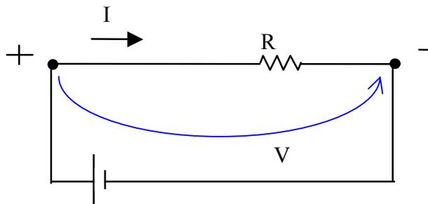
Neste circuito  $V = R I$ , onde  $R$  é a resistência equivalente à série de resistências  $R_1$ ,  $R_2$ ,  $R_3$ .
