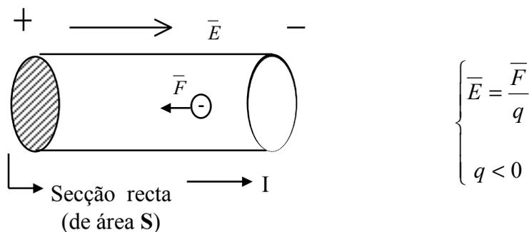
O valor da intensidade de corrente eléctrica depende da “quantidade” de electrões livres que atravessam uma secção recta do condutor, por unidade de tempo.
