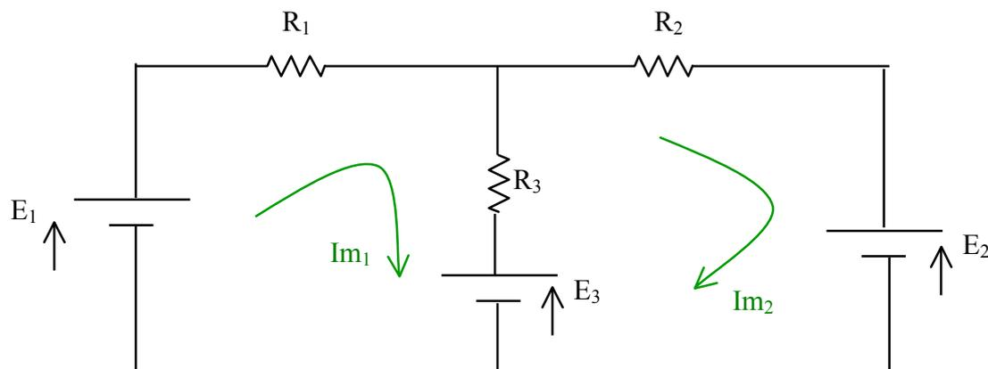
Para cada malha do circuito define-se uma corrente, chamada corrente de malha. Haverá ramos percorridos por uma só corrente de malha e outros percorridos por mais do que uma. Aplicando-se a cada malha a 2ª lei de Kirchhoff (leis das malhas) obter-se-á,
