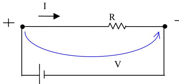
Neste circuito  $V = R I$ , logo  $I = \frac{V}{R}$ , onde  $R$  é a resistência equivalente ao paralelo de resistências  $R_1$ ,  $R_2$ ,  $R_3$ .
