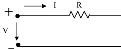
Por definição de d.d.p., sabe-se que  $V = \frac{W}{Q}$ , isto é, o trabalho realizado pelas forças do campo eléctrico para mover os electrões livres no interior do condutor é
