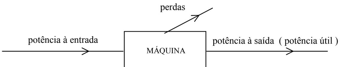
$$\eta_{\text{máquina}} = \frac{\text{potência à saída (potência útil)}}{\text{potência à entrada}}$$
