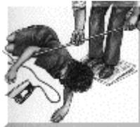
Figura 20: Como afastar uma pessoa de um contacto eléctrico
