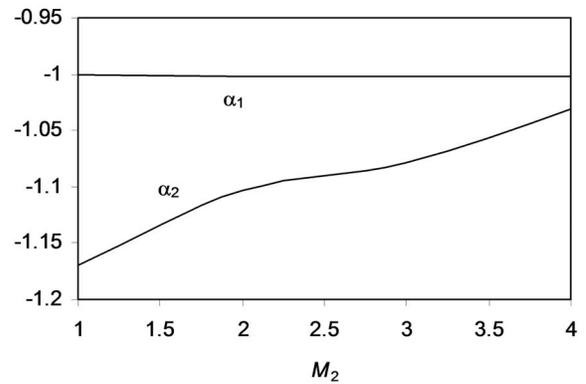
Fig. 7 Parameters  $\{m_k^{-1}, \alpha_k\}$ ,  $k=1,2$ , versus  $M_2$  for  $M_1=1.0$  kg,  $h=10^{-2}$  m,  $n=10^3$  microelements,  $T_w=1.0$  s,  $dt=5.0 \times 10^{-6}$  s
