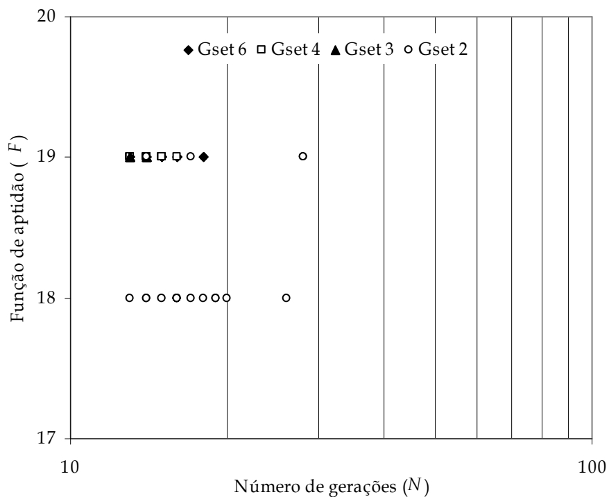
Figura 5. 7- Função de aptidão F ( \delta = 0 ) versus número de gerações N necessária para obter a solução para o circuito SOM1, utilizando o AM.
